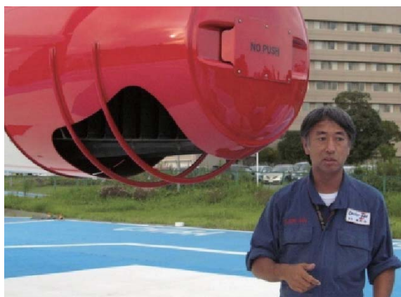
写真 9. 風間機長とヘリ尾翼のエア吹き出し口
